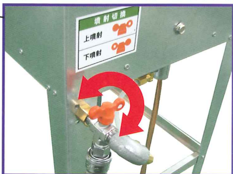
コックで上噴射・下噴射を切り替え
